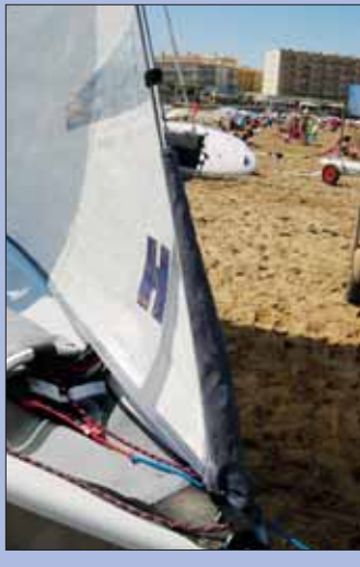
El polipasto para la tensión del stay queda resguardado dentro de una funda con velcro.
