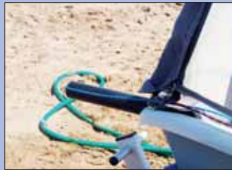
El botalón es retráctil, a modo de skiff, y queda totalmente recogido en ceñida.
