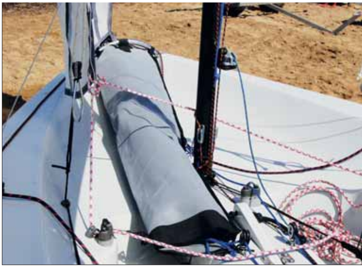
▲ El escotero del foque es fijo y con escota sin fin. Además, podremos trimar el bateo de la baluma con el balumero que incorpora el foque.
