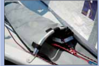
El calceín viene con un arco de acero inoxidable para proteger el asimétrico.
