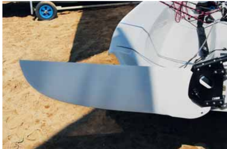
Pensado para varadas en la playa, el timón cuenta con una pala abatible. ▼
