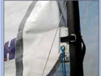
El puño de amura se fija al palo mediante una cinta textil con el ollao para el cunningham desmultiplicado algo más abajo.
