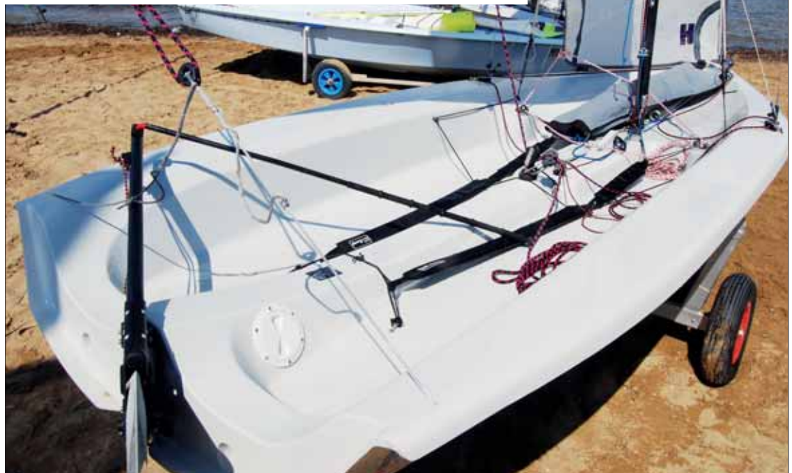
La escota de la mayor es con pata de ▶ gallo en popa y la bañera cuenta con dos imbornales para el autovaciado de agua.
