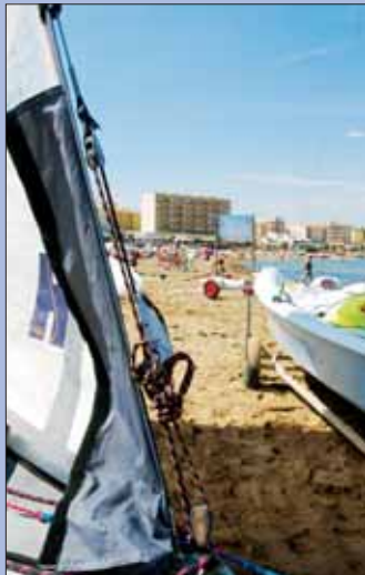
El polipasto para la tensión del stay queda resguardado dentro de una funda con velcro.
