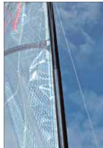
En busca de la mejor flexión del palo, éste combina el aluminio en la parte baja y el carbono en la superior.
