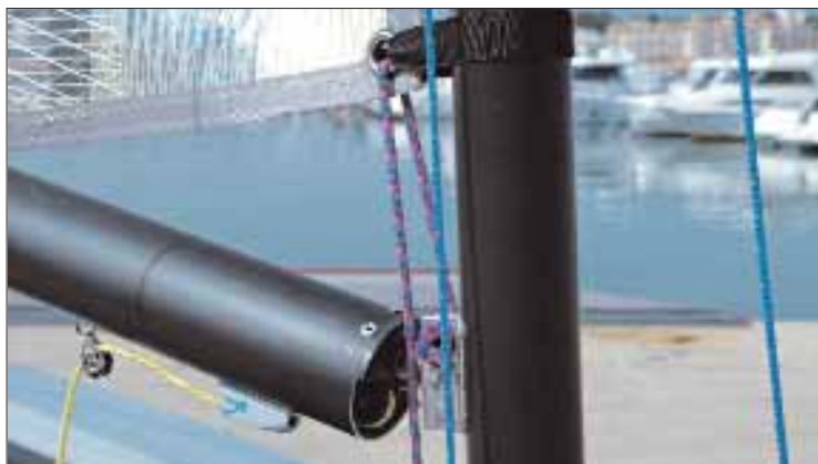
Botavara y palo quedan unidos por un resistente pinzote metálico, que además sirve para montar parte del cunningham.
