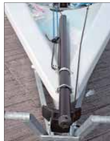
▲ El kit de spi asimétrico cuenta con un botalón retráctil en proa, que sale de su posición de descanso mientras se iza la vela, integrado en un mismo mecanismo.
