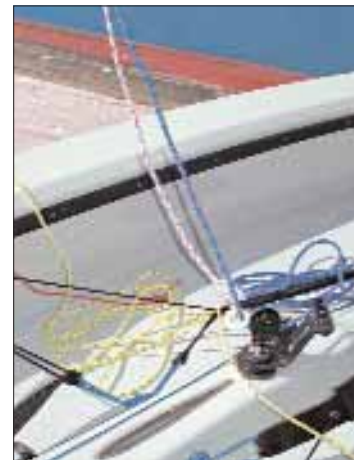
El montecarlo se sitúa en medio de la bañera, tras finalizar el recorrido de la escota de la mayor desde popa.
