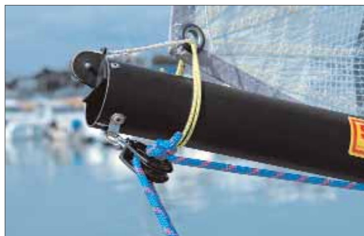
Botavara y palo quedan unidos por un resistente pinzote metálico, que además sirve para montar parte del cunningham.
