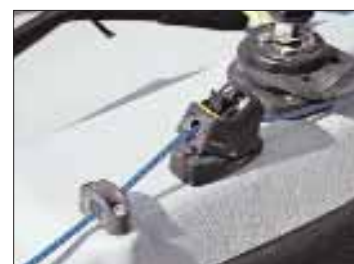
▲ Las mordazas se distribuyen estratégicamente en la embarcación, ya sea en los bancos laterales o tras el montecarlo.
