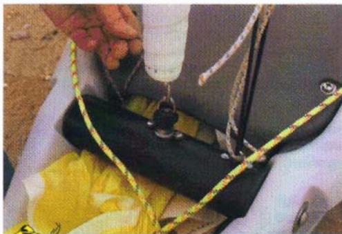
Le tambour de l'enrouleur est caché dans le tube.
